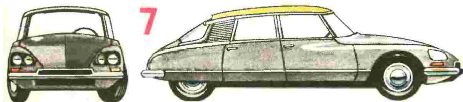
4. «Крайслер», модель «эрфлор» — «воздушный поток» (1934—1936). Конструктор Г. Бюринг. 5. Обтекаемый кузов А. Никитина на шасси ГАЗ-А (1935). 6. Обтекаемый кузов В. Камма на шасси автомобиля БМВ (1938). 7. Автомобиль «ситроен», модель DS-21 (1956—73). Привод на передние колеса. Показана последняя модель с поворотными фарами.
