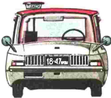
1. «Марнское такси», фирмы «Рено» (Франция, 1908—1912). Двигатель 2-цилиндровый, около 10 л. с. Скорость — 40 км/ч.
