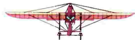
04. «БЛЕРИО XI» (Франция, 1909). Двигатель — «Анзани», 25 л. с. Полетный вес — 320 кг. Площадь крыла — 14 м 2 . Размах — 7,2 м. Скорость — 70 км/ч.
