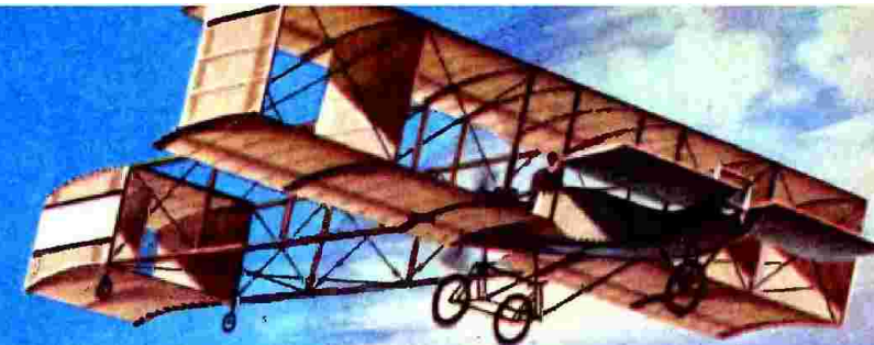
1. «Воздухолетательный снаряд» А. Можайского (Россия, 1885). Двигатели паровые, конструкции Можайского, общая мощность — 30 л. с. Площадь крыла — 370 м 2 . Полетный вес — ок. 950 кг. Изображение самолета за отсутствием рабочих чертежей воспроизведено по схеме из «Прилиегия», выданной из департамента Торговли и Мануфактуры в 1881 г. капитану 1-го ранга Можайскому на воздухолетательный снаряд».
