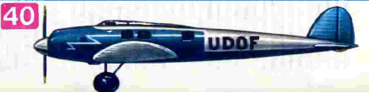
40. Пассажирский самолет «Хейнкель» Хе-70 (Германия, 1932). Двигатель — 1х БМВ-VI, 630 л. с., размах — 14,8 м, длина — 11,5 м, площадь крыла — 36,50 м 2 , вес пустого — 2300 кг, полетный вес — 3310 кг, количество пассажиров — 5 чел., экипаж — 2 чел., скорость максимальная — 362 км/ч.
