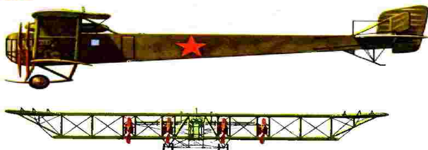
10. «Илья Муромец», серия В (Россия, 1914). Экипаж — 4 чел. Двигатели — «Аргус» (2×140 л. с. и 2×125 л. с.). Полетный вес — 4400 кг. Размах — 29,8 м (верхнее крыло), 21,0 м (нижнее). Длина — 17,10 м. Площадь крыльев — 125 м 2 . Полная нагрузка — 1500 кг. Максимальная скорость — 120 км/ч. Вооружение — 3 пулемета, 500 кг бомб.
